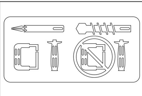
**PRECAUCIÓN:** Utilice el mango lateral únicamente para operaciones de cincelado, desincrustación o demolición. No lo utilice para perforar concreto, mampostería, etc. La herramienta no puede sujetarse adecuadamente con este mango lateral al momento de perforar.
